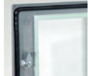
**Polyuréthane** : c'est la solution la plus commune, car elle fournit une excellente isolation de -20 ° à 60 °. Le joint est appliqué directement sur la porte par un procédé robotisé qui assure un positionnement parfait. C'est un procédé standard pour tous les produits.
